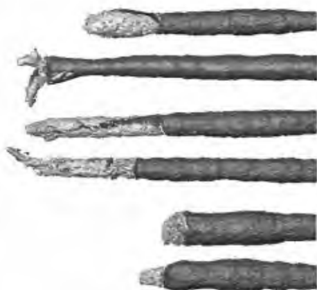
Rys. 9. Objętości kanału (ciemnoszary) i metalu (jasnoszary) w piaskowcu przy wzroście podciśnienia [10]
