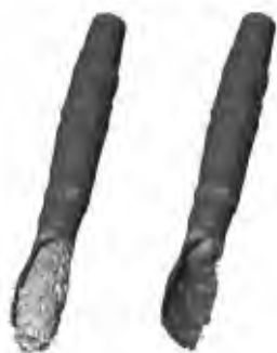
Rys. 10. Zbliżenie objętości kanału i metalu (po lewej) przy podciśnieniu 750 psi (5,2 MPa) oraz otwartej przestrzeni pierścieniowej wokół zbitki metalowej (po prawej, metal usunięto)
