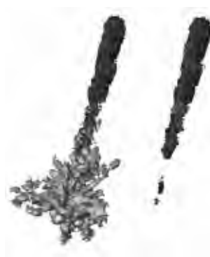
Rys. 12. Objętości kanału (ciemnoszary) i metalu (jasnoszary) w wapieniu Bedford przy zwiększaniu podciśnienia [10]
