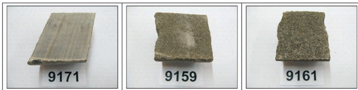
Rys. 5. Zdjęcia próbek poddanych badaniu metodą micro-CT
