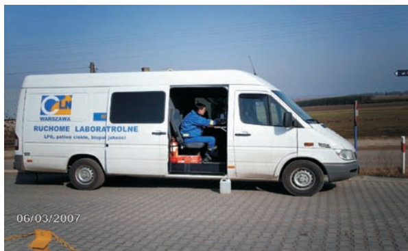
Fot. 1. Część pasażerska przystosowana do wykonywania analiz składu LPG
