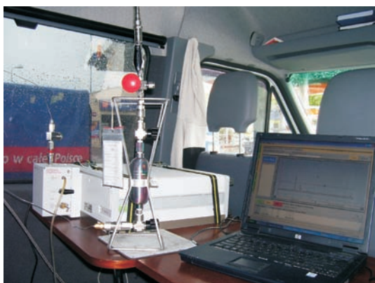
Fot. 3. Wykonywanie analizy składu LPG na mikrochromatografie gazowym
