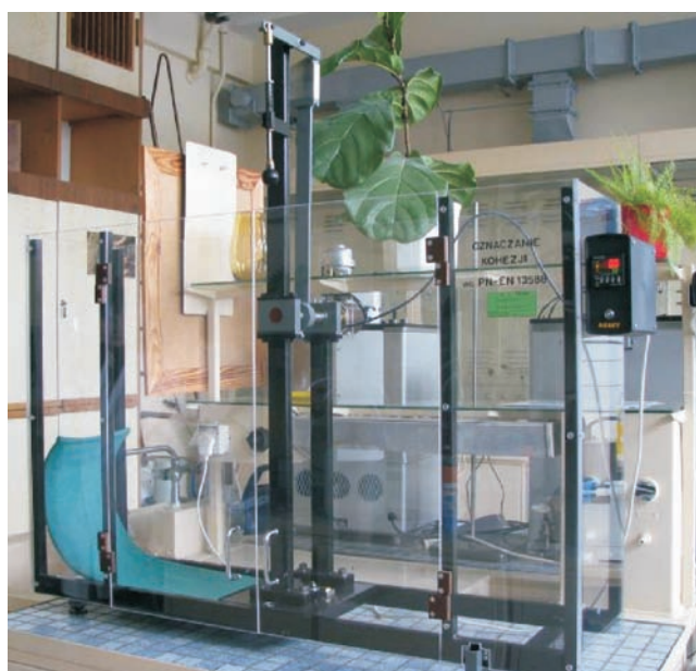
Rys. 6. Urządzenie pomiarowe do oznaczania kohezji metodą testu wahadłowego według PN-EN 13588 (fot. INiG Kraków)
