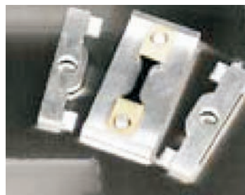
Rys. 5. Kształt próbek asfaltu do badania rozciągania według PN-EN 13587 [3]
