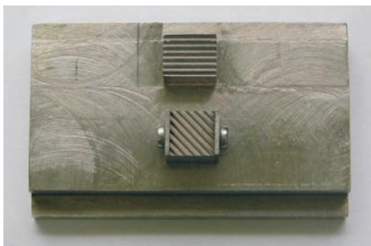
Rys. 7. Zestaw badawczy do oznaczania kohezji metodą testu wahadłowego według PN-EN 13588 (fot. INiG Kraków)
