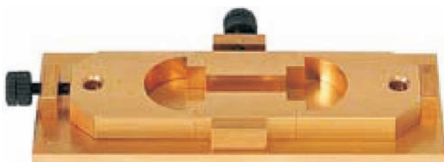
Rys. 2. Kształt próbek asfaltu do badania siły rozciągania według PN-EN 13589 [4]
