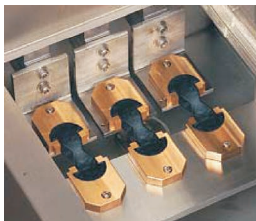
Rys. 3. Sposób zamocowania próbek w duktylometrze [4]
