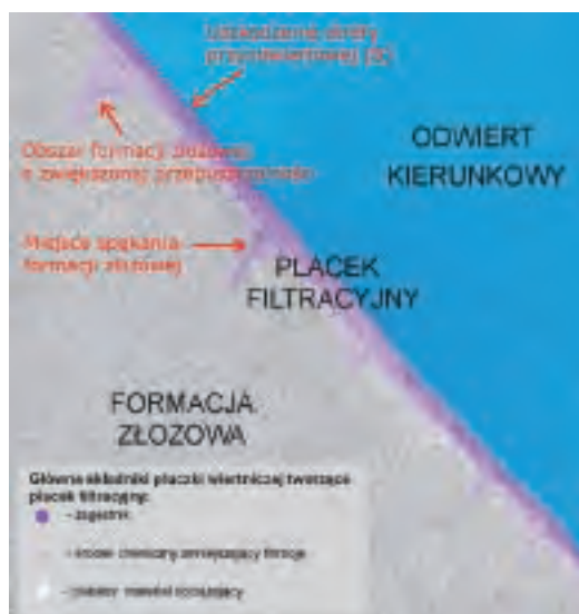
Rys. 1. Wizualny schemat uszkodzenia strefy przyodwiertowej, związany z tworzeniem się osadu filtracyjnego [10]
