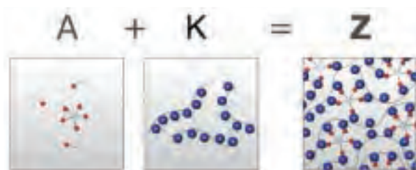
Rys. 3. Tworzenie się płynu lepkosprężystego (Z) w wyniku wymieszania dwóch środków powierzchniowo-czynnych: anionowego i kationowego (A, K) [2]
