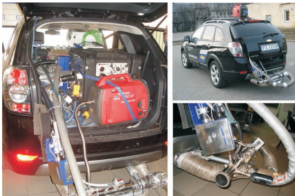
Rys. 3. Widok analizatora SEMTECH DS (do pomiarów emisji związków gazowych) oraz licznika cząstek stałych, wraz ze spektrometrem mas (do pomiaru liczby cząstek stałych), zamontowanych w pojeździe podczas badań
