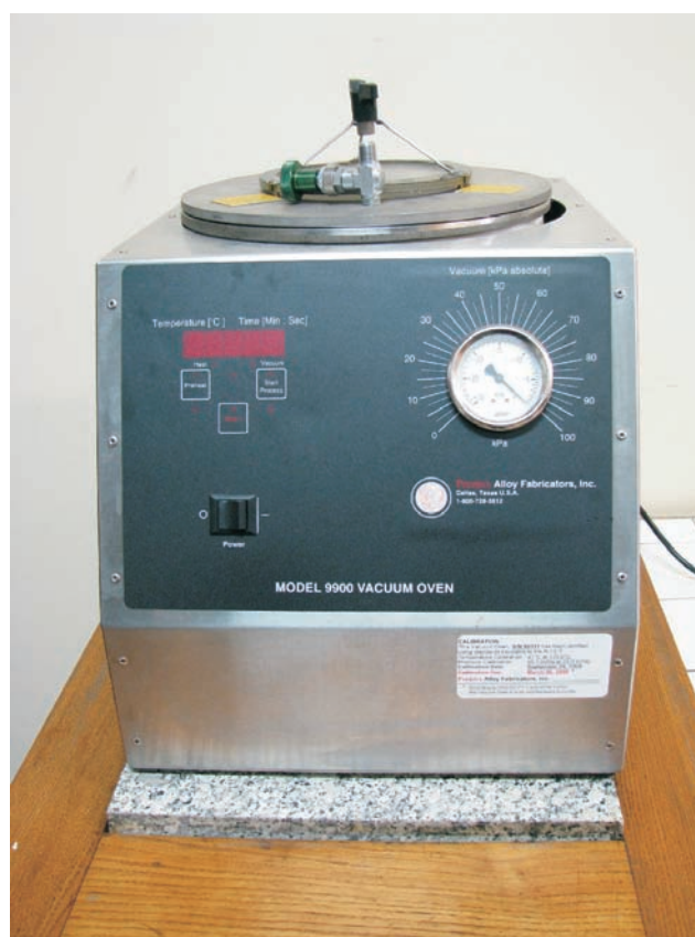
Rys. 6. Piec próżniowy do odpowietrzania próbek asfaltu po starzeniu w komorze ciśnieniowej PAV (fot. INiG Kraków)
