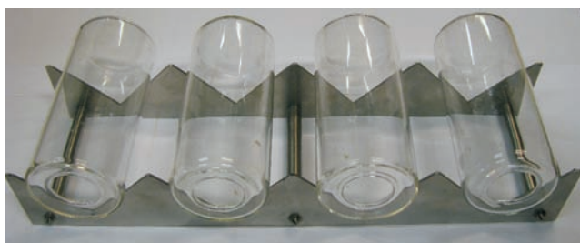
Rys. 2. Szklane pojemniki, w których próbka asfaltu poddawana jest starzeniu według PN-EN 12607-1 (fot. INiG Kraków)
