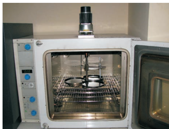
Rys. 3. Suszarka do badania odporności na starzenie pod wpływem ciepła i powietrza metodą TFOT, według PN-EN 12607-2 (fot. INiG Kraków)
