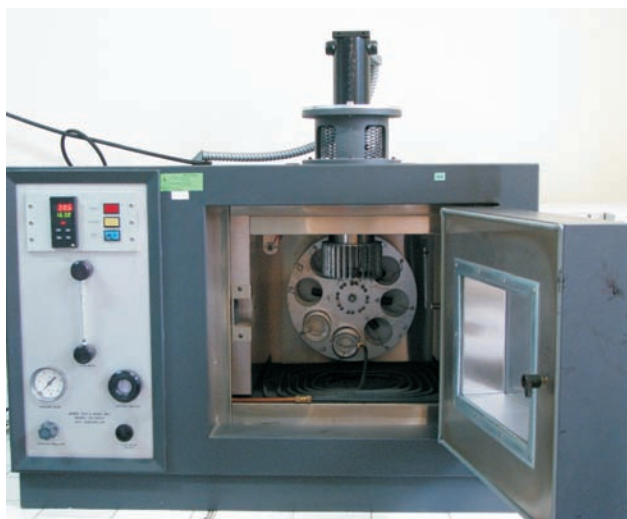
Rys. 1. Suszarka do badania odporności na starzenie pod wpływem ciepła i powietrza metodą RTFOT, według PN-EN 12607-1 (fot. INiG Kraków)
