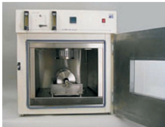
Rys. 7. Suszarka do badania przyśpieszonego długoterminowego starzenia metodą RCAT, według PN-EN 15323 [3]
