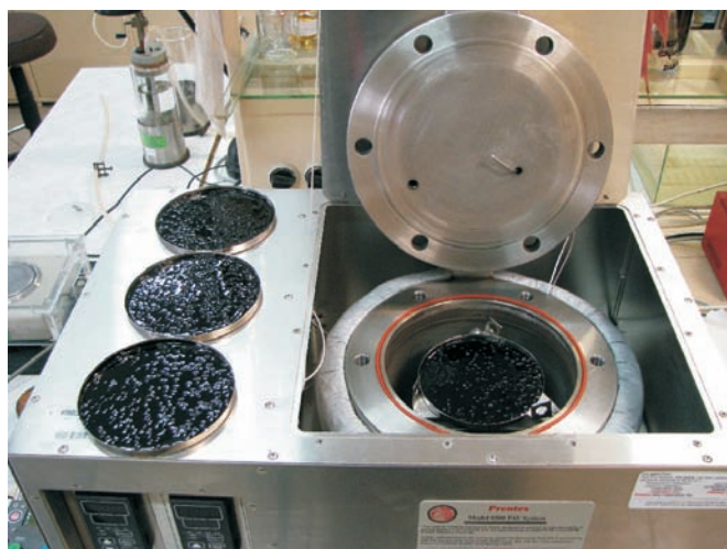
Rys. 5. Komora starzenia ciśnieniowego PAV, do badania starzenia długoterminowego według PN-EN 14769 (fot. INiG Kraków)
