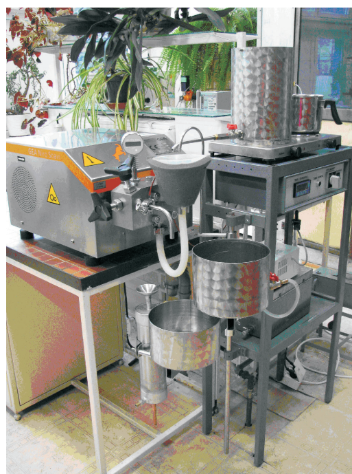
Rys. 2. Stanowisko do wytwarzania emulsji woskowych metodą homogenizacji ciśnieniowej
