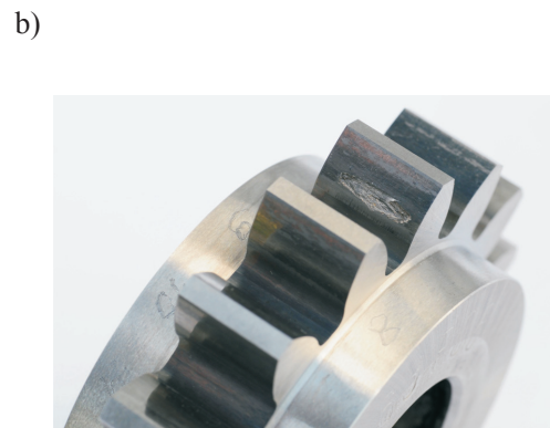
Rys. 3. Badanie pittingu samochodowych olejów przekładniowych metodą PT C/10/90
