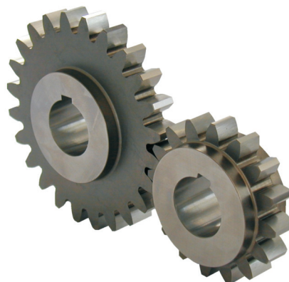
Fot. 2. Para kół testowych typu C-PT do badania pittingu
