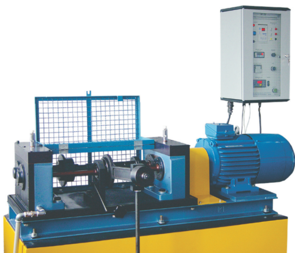
Fot. 3. Stanowisko przekładniowe T-12U
