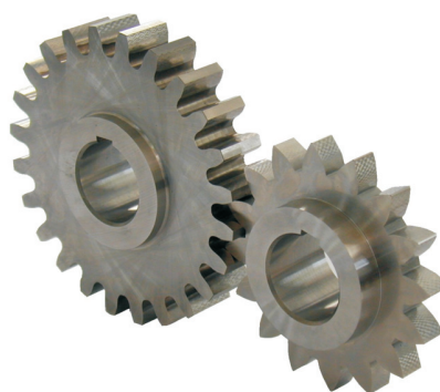
Fot. 1. Para kół testowych typu A10 do badania „zacierania szokowego”
