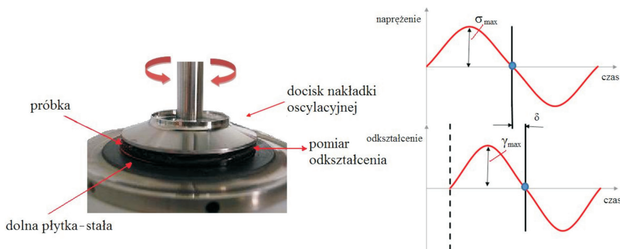
Rys. 1. Zasada pomiaru oscylacyjnego za pomocą układu płytka-płytką
