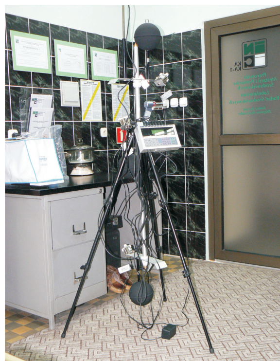
Rys. 1. Najnowszej generacji zestaw aparatury do badania mikroklimatu typu BABUC-A, produkcji włoskiej
