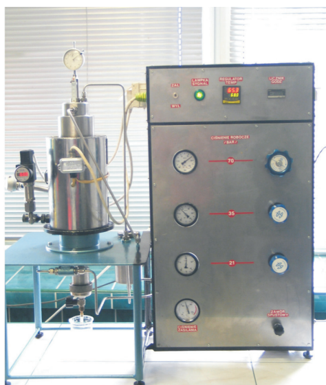
Rys. 3. Aparat do badania migracji gazu przez wiążący zaczyn cementowy w warunkach otworopodobnych
