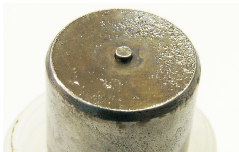
Fot. 3. Ubytki materiału na powierzchni czołowej rozpylacza paliwa, silnika badawczego CFR Waukesha (fot. INiG Kraków)
