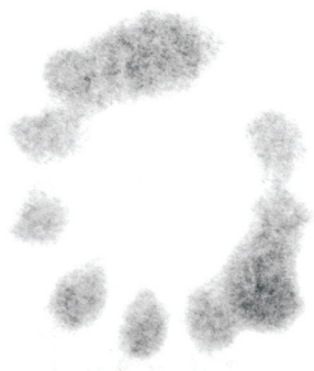
Fot. 2. Rozkład rozpylenia strugi paliwa przez wtryskiwacz silnika CFR Waukesha, po oznaczeniu olejów napędowych wątpliwego pochodzenia (fot. INiG Kraków)
