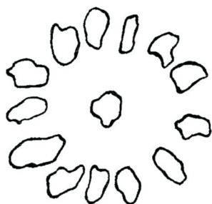
Rys. 1. Wzorcowy rozkład rozpylenia strugi paliwa przez wtryskiwacz, według ASTM D-613 (rys. norma ASTM D-613)
