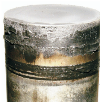
Fot. 5. Nagar na denku i na ściankach bocznych tłoka koła ręcznego, służącego do zmiany objętości komory spalania silnika badawczego (fot. INiG Kraków)
