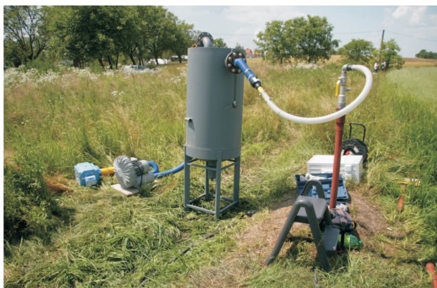
Fot. 1. Zestaw do podciśnieniowego udrażniania sond degazacyjnych
