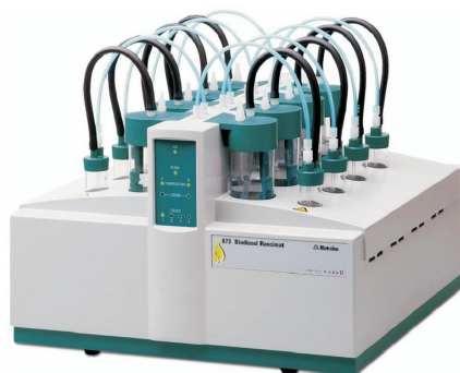
Rys. 2. Aparat do badań stabilności oksydacyjnej zgodnie z metodami PN-EN 14112 [8] oraz EN 15751 [1]
