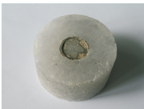
Fot. 3. Próbkę do badań przyczepności kamienia cementowego do soli
