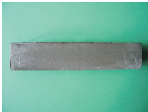
Fot. 1. Próbkę do badań wytrzymałości na zginanie i ściskanie
