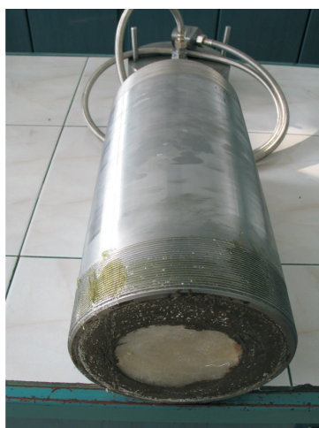
Fot. 10. Rdzeń solny umieszczony w rurze okładzinowej 7" i zalany zaczynem cementowym
