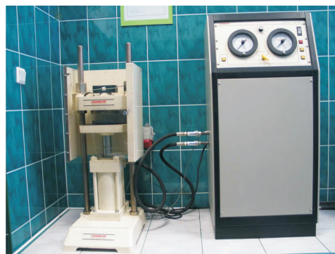
Fot. 2. Maszyna wytrzymałościowa do oznaczenia parametrów mechanicznych próbek
