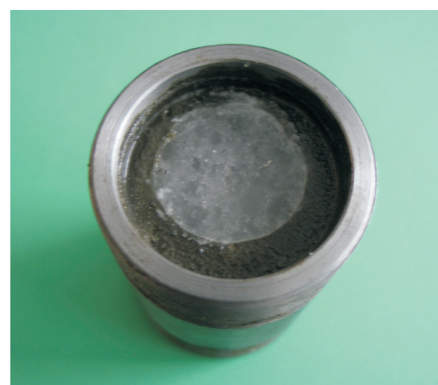
Fot. 6. Próbkę do badania przepuszczalności na kontakcie: sól-kamień cementowy
