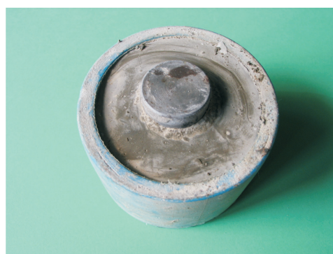
Fot. 4. Próbkę do badań przyczepności kamienia cementowego do stalowej rury
