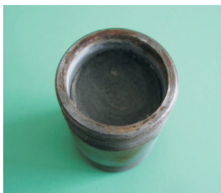
Fot. 5. Próbkę do badania przepuszczalności kamienia cementowego dla gazu
