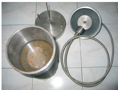
Fot. 9. Rdzeń solny umieszczony w rurze okładzinowej 7" i zalany zaczynem cementowym
