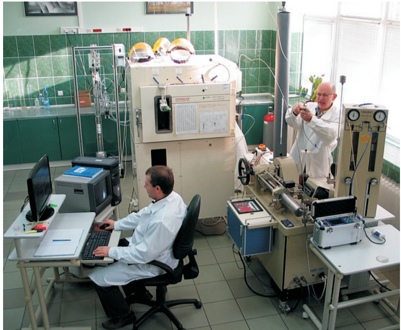
Rys. 6. Stanowisko badawcze do modelowania procesów wypierania [4]
