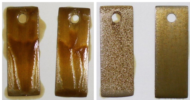
Ropa naftowa bez inhibitora (próba zerowa) Ropa naftowa z inhibitorem parafin w ilości 750 mg/kg
