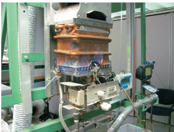
Rys. 10. Wygląd palnika przy przepływie powietrza 211,9 kg/h
