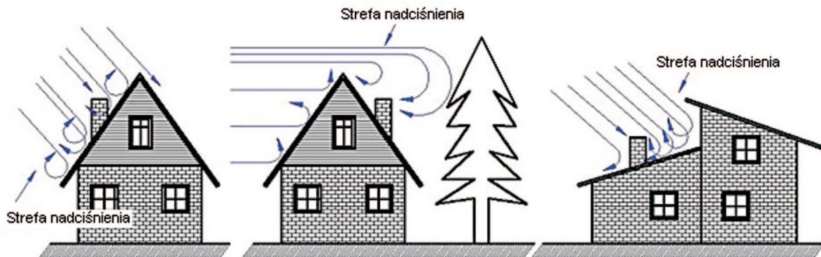
Rys. 8. Zaburzenia przepływu powietrza w okolicach przewodów wentylacyjno-spalinowych [8]
