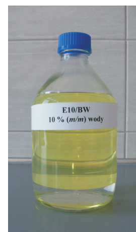
Fot. 1 Próbkę E10/BW o zawartości wody 10% (m/m) po rozwarstwieniu
