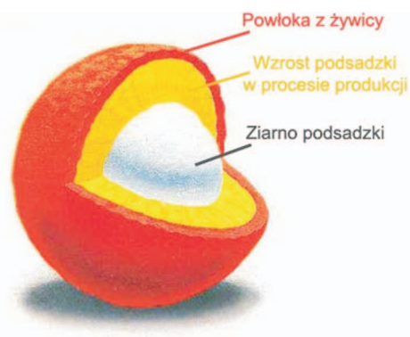
Rys. 3. Przykładowe pokrycie ziarna podsadzki powłoką z żywicy [2]
