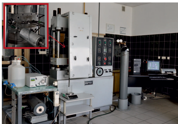
Rys. 6. Schemat stanowiska Proppant Conductivity wraz z komorą API do badań materiału podsadzkowego
