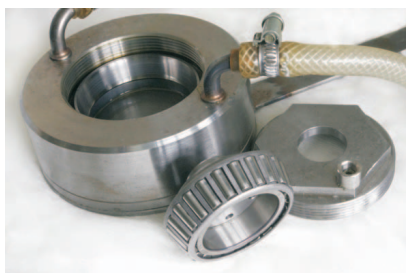
Fot. 1. Elementy składowe głowicy z łożyskiem stożkowym (fot. INiG)
