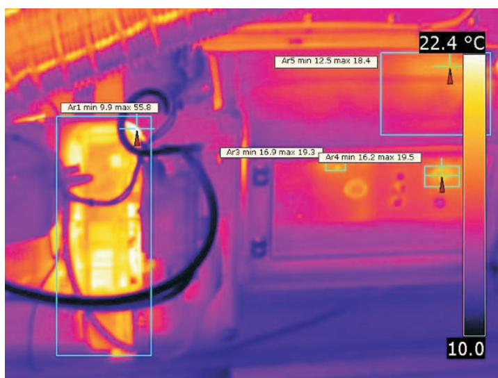
Rys. 1. Fragment badanej nagrzewnicy – zaznaczono najcieplejsze punkty w wybranych obszarach
