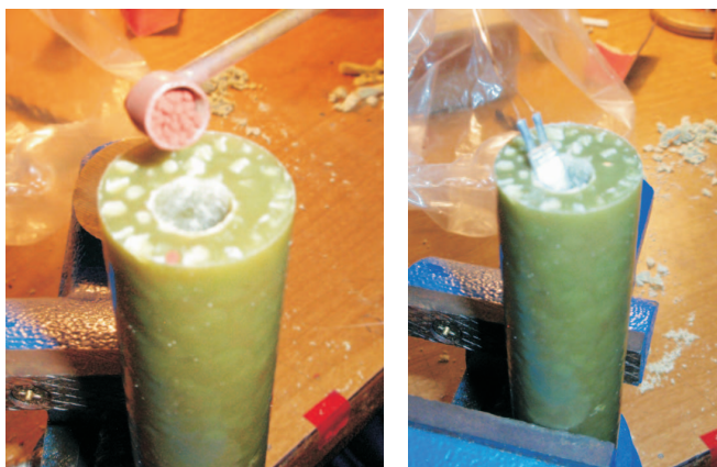
Rys. 5. Kolejne etapy przygotowania zespołu inicjowania zapłonu propelantu
