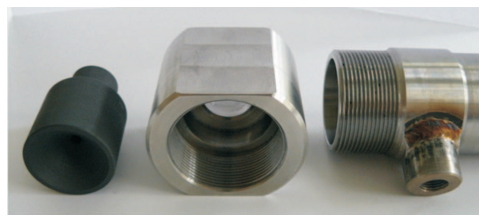
Rys. 2. Części silnika laboratoryjnego do badania propelantów. Po lewej dysza wylotowa, w środku głowica silnika, w której umieszczona jest dysza, po prawej gwintowana końcowa część korpusu, umożliwiającą dokręcenie głowicy, oraz charakterystyczny króciec pomiarowy do usytuowania piezoelektrycznego przetwornika ciśnienia
