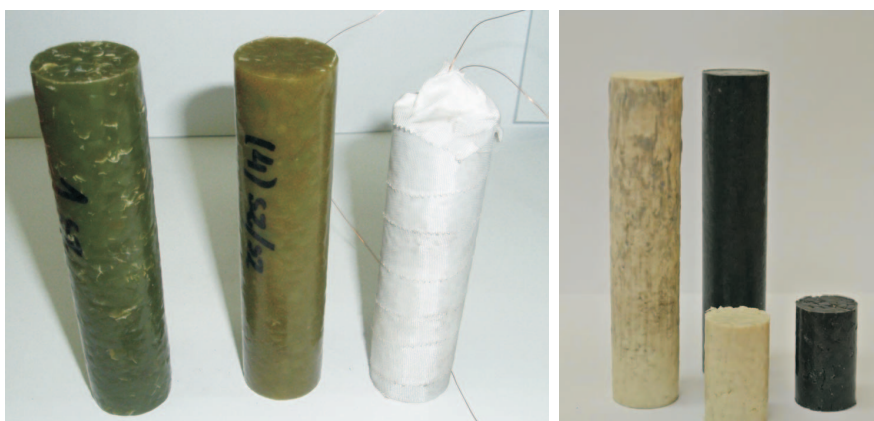
Rys. 4. Przykładowe wypraski paliwa przygotowane do badań na silniku laboratoryjnym [1]
