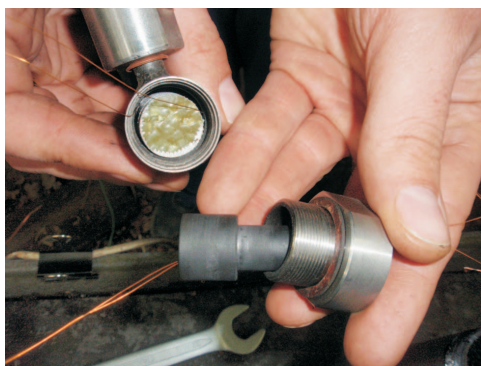
Rys. 6. Instalowanie próbki paliwa w komorze silnika laboratoryjnego
