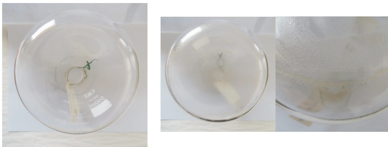
Rys. 1. Widok kolb po sączeniu mieszaniny bazowego oleju napędowego, syntetycznego oleju silnikowego 5W40 i pakietu (po stronie lewej pakiet ACE 439, po prawej: ACE 441)
