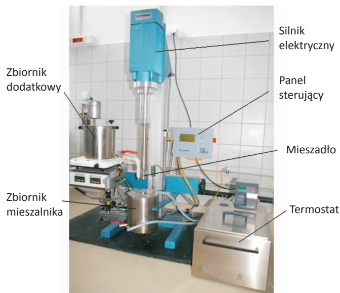
Rys. 3. Stanowisko mieszalnika DISPERMAT CA 60M
