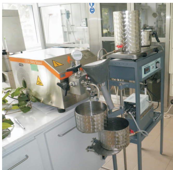
Rys. 1. Stanowisko do wytwarzania mikroemulsji woskowych metodą homogenizacji ciśnieniowej
