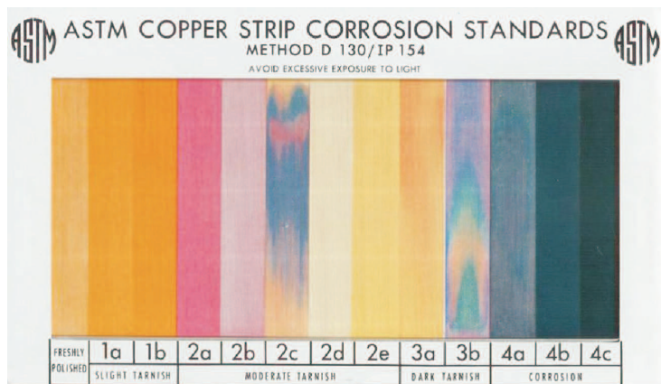
Rys. 1. Wzornik barwny do oceny stopnia korozji płytki miedzianej załączony do normy ASTM D 130 [2]
