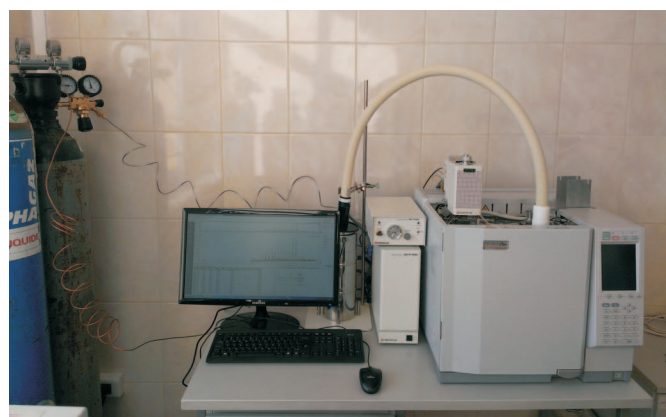
Rys. 1. Wielokanałowy pirolizer (Multi-Shot Pyrolyzer EGA/PY-3030D) firmy Frontier Laboratories sprzężony z chromatografem gazowym (GC-2010 Plus) firmy Shimadzu
