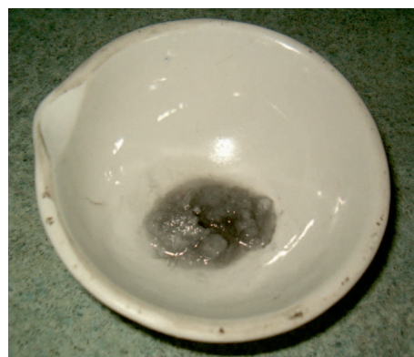
Rys. 3. Hydrat na etapie rozkładu, wydobyty z komory badawczej [17]
