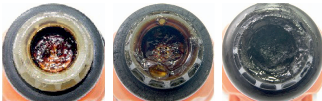
Rys. 3. Osady na końcówce wtryskiwacza silnika FFV eksploatowanego na paliwach E85 (fot. INiG – PIB)
