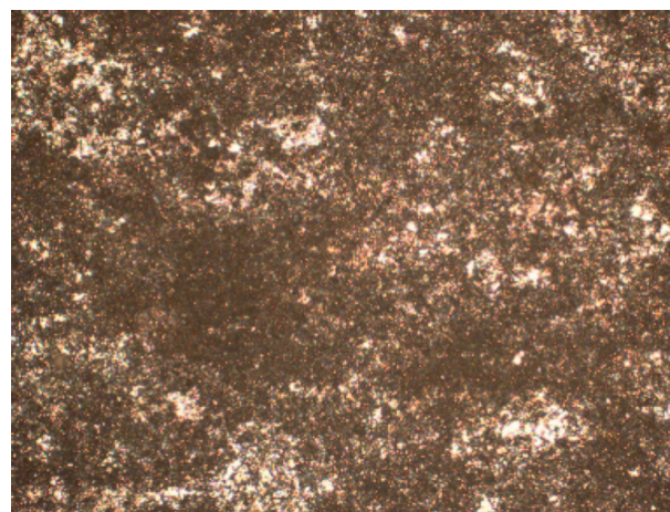
Rys. 4. Zdjęcie mikroskopowe (powiększenie około 50 ×) powierzchni próbki stali gatunku J-55 poddanej działaniu cieczy poreakcyjnej po kwasowaniu K bez dodatku inhibitora w 50°C
