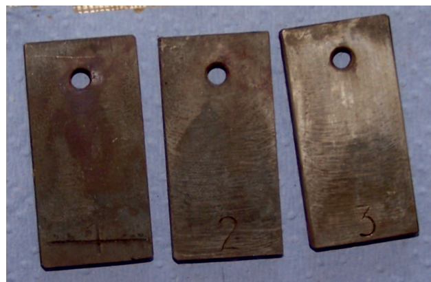
Rys. 3. Zdjęcie próbek stali gatunku J-55 poddanych działaniu cieczy po kwasowaniu K bez dodatku inhibitora w 50°C
