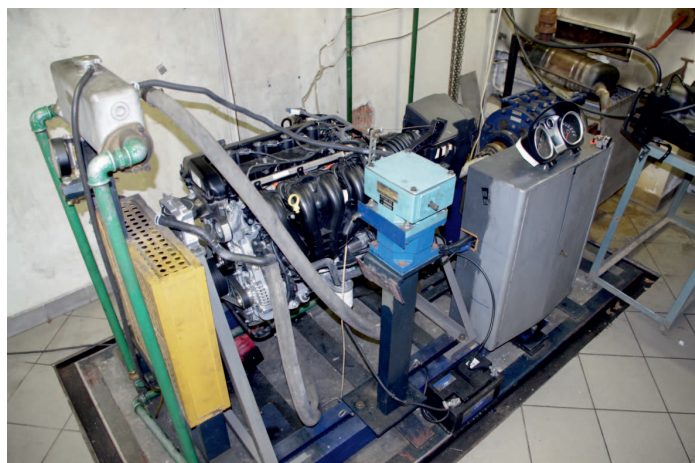
Rys. 1. Widok stanowiska badawczego z silnikiem Ford 1.8L Duratec-HE PFI FFV zasilanego paliwem etanolem E20 i smarowym olejem silnikowym SAE 5W-30 (ACEA A5/B5) (fot. INiG – PIB)
