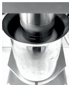
Fot. 1. Rotor zanurzony w płuczce (wytwarzanie osadu płuczkowego) Phot. 1. A rotor immersed in a mud (production of mud sludge)
