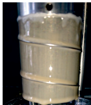
Fot. 3. Osad płuczkowy wytworzony na zmodyfikowanej powierzchni rotora
