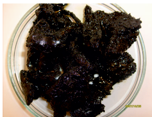
Fot. 6. Zżelowany olej SAE 10W/40 API CF zawierający sadzę Phot. 6. Gelled oil SAE 10W/40 API CF containing soot
