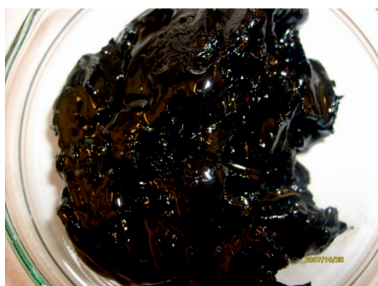
Fot. 5. Zżelowany olej SAE 15W/40 API CG-4 zawierający sadzę Phot. 5. Gelled oil SAE 15W/40 API CG-4 containing soot
