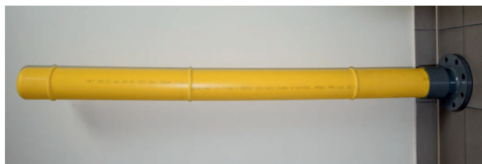
Rys. 8. Próbkę ze zgrzewem doczołowym po zginaniu przygotowaną do badania wytrzymałości na ciśnienie wewnętrzne przy próbie niszczącej
