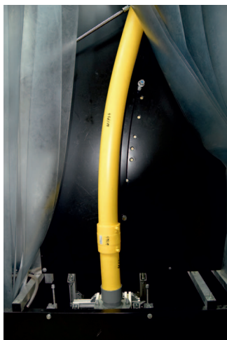
Rys. 7. Próbkę ze zgrzewem elektrooporowym w trakcie zginania
