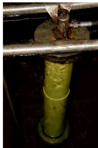
Rys. 5. Próbka rurowa ze zgrzewem doczołowym po oddziaływaniu sił osiowych w trakcie badania odporności na ciśnienie wewnętrzne do zniszczenia
