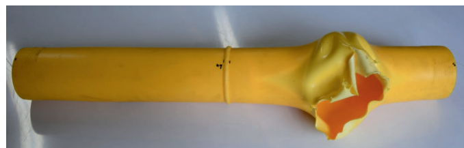
Rys. 1. Próbką rury ze zgrzewem doczołowym – z rur PA 12 d_n 110 mm, SDR 11 po badaniu odporności na ciśnienie wewnętrzne do zniszczenia
