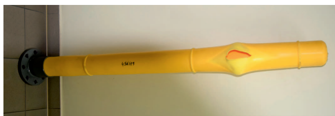
Rys. 9. Przykładowa próbkę ze zgrzewem doczołowym obciążona zginaniem po badaniu wytrzymałości na ciśnienie wewnętrzne przy próbie niszczącej
