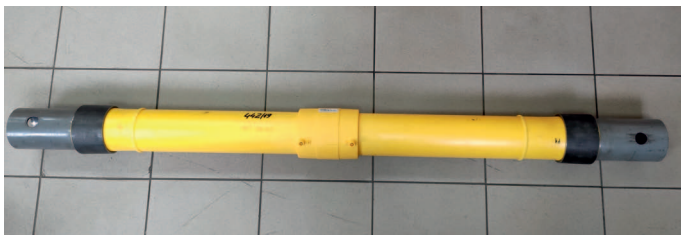
Rys. 2. Próbkę ze zgrzewem elektrooporowym – z mufy i rur PA 12 d_n 110 mm, SDR 11, przygotowaną do badania sił osiowych
