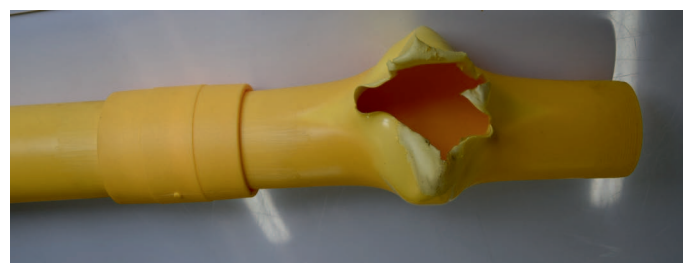
Rys. 6. Próbka ze zgrzewu elektrooporowego – z rur i mufy PA 12 d_n 110 mm, SDR 11, po badaniu odporności na ciśnienie wewnętrzne do zniszczenia
