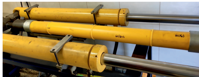
Rys. 3. Próbkę ze zgrzewem doczołowym – z rury PA 12 d_n 110 mm, SDR 11, w trakcie badania sił osiowych
