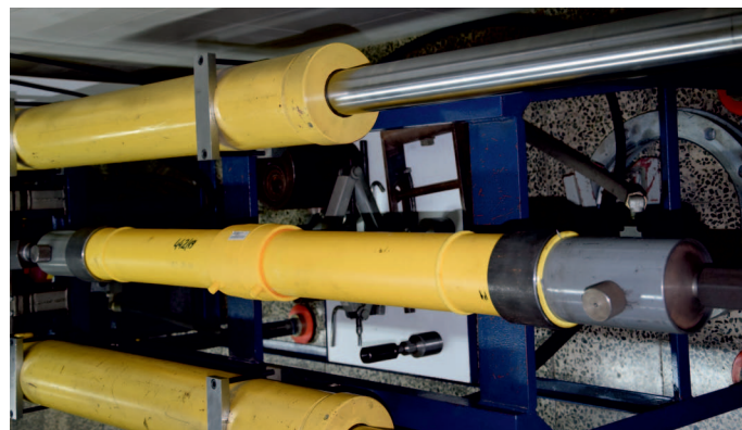
Rys. 4. Próbkę ze zgrzewem elektrooporowym – z mufy i rur PA 12 d_n 110 mm, SDR 11, w trakcie badania sił osiowych
