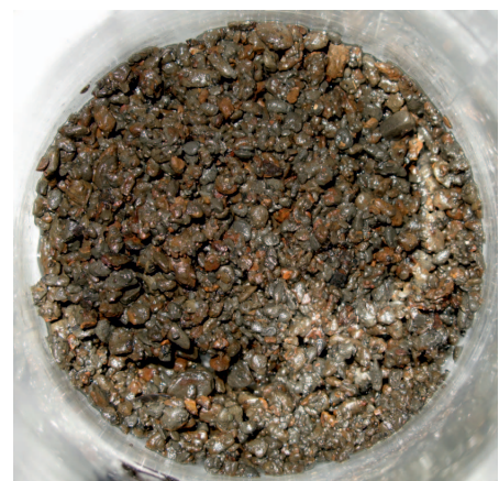
Fot. 6. Osad iłowy w postaci zwiercin po oddziaływaniu cieczy emulsyjnej O/W i wody Fig. 6. Clay sludge in the form of cuttings after the interaction of O/W emulsion fluid and water
