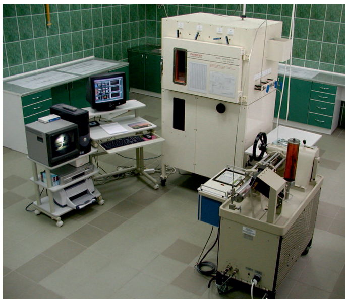
Rys. 2. Aparatura do badań PVT firmy Chandler Engineering – Model 2370-3000-G PVT System (Lubaś et al., 2012; Szufflita i Kuśnierczyk, 2017; Szufflita et al., 2018)
