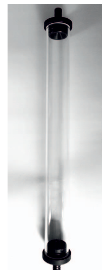
Rys. 8. Widok rury z tworzywa wraz uszczelnieniami, w których umocowano dopływ i odpływ cieczy wiertniczej
