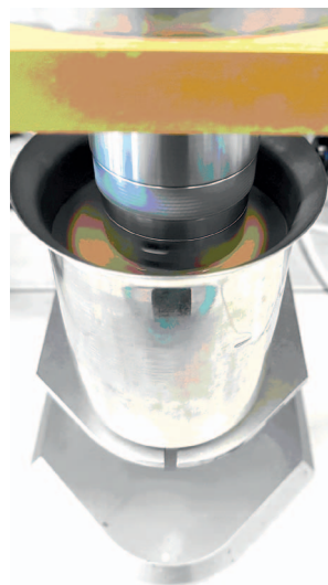
Rys. 4. Rotor zanurzony w płuczce (wytwarzanie osadu płuczkowego)
