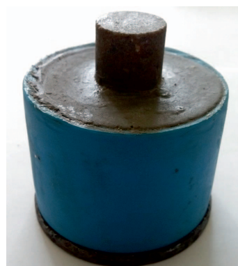
Rys. 9. Próbkę przygotowaną do badań przyczepności na kontakcie stwardniały zaczyn cementowy–skała
