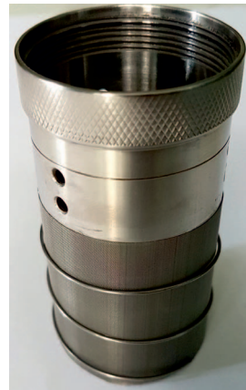
Rys. 13. Widok rotora zmodyfikowanego przy użyciu siatki stalowej Fig. 13. View of the rotor modified with a steel mesh
