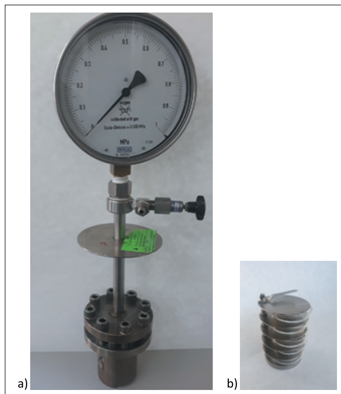
Rysunek 1. Aparat do oznaczania odporności na utlenianie według PN-C-04143: a) aparat, b) podstawka (fot. INiG – PIB)
