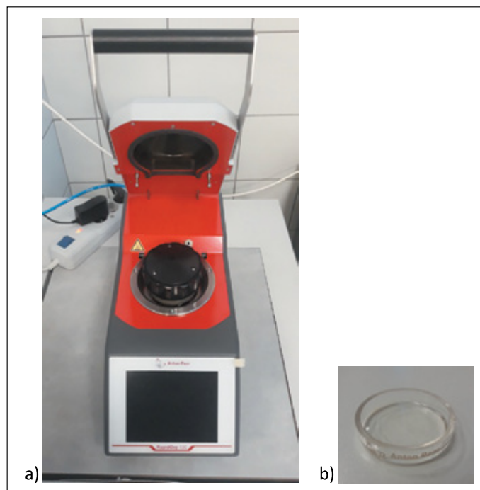
Rysunek 4. Aparat RapidOxy 100 do oznaczania stabilności termooksydacyjnej według ASTM D8206-18: a) aparat, b) naczynie szklane (fot. INiG – PIB)
